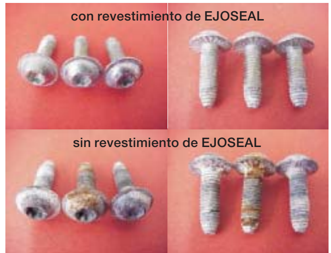
Corrosión después de 456 horas de prueba según DIN 50021 (grosor de capa de cinc 8 \mu azul)
